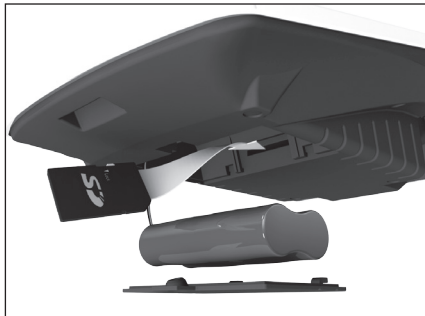
Obrázok 2.8 – Zavedenie SD karty do pokladnice
