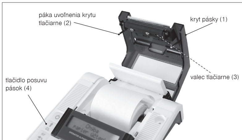
Obrázok 2.6 – Zavedenie papierovej termo pásky do tlačiarne pokladnice
