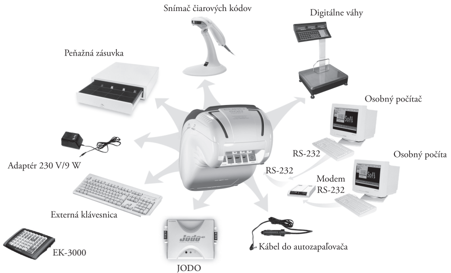
Obrázok 2.3 – Externé zariadenia pripojiteľné k pokladniciam Euro-500T/TE/TX
